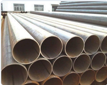
直缝钢管堆放（一）
